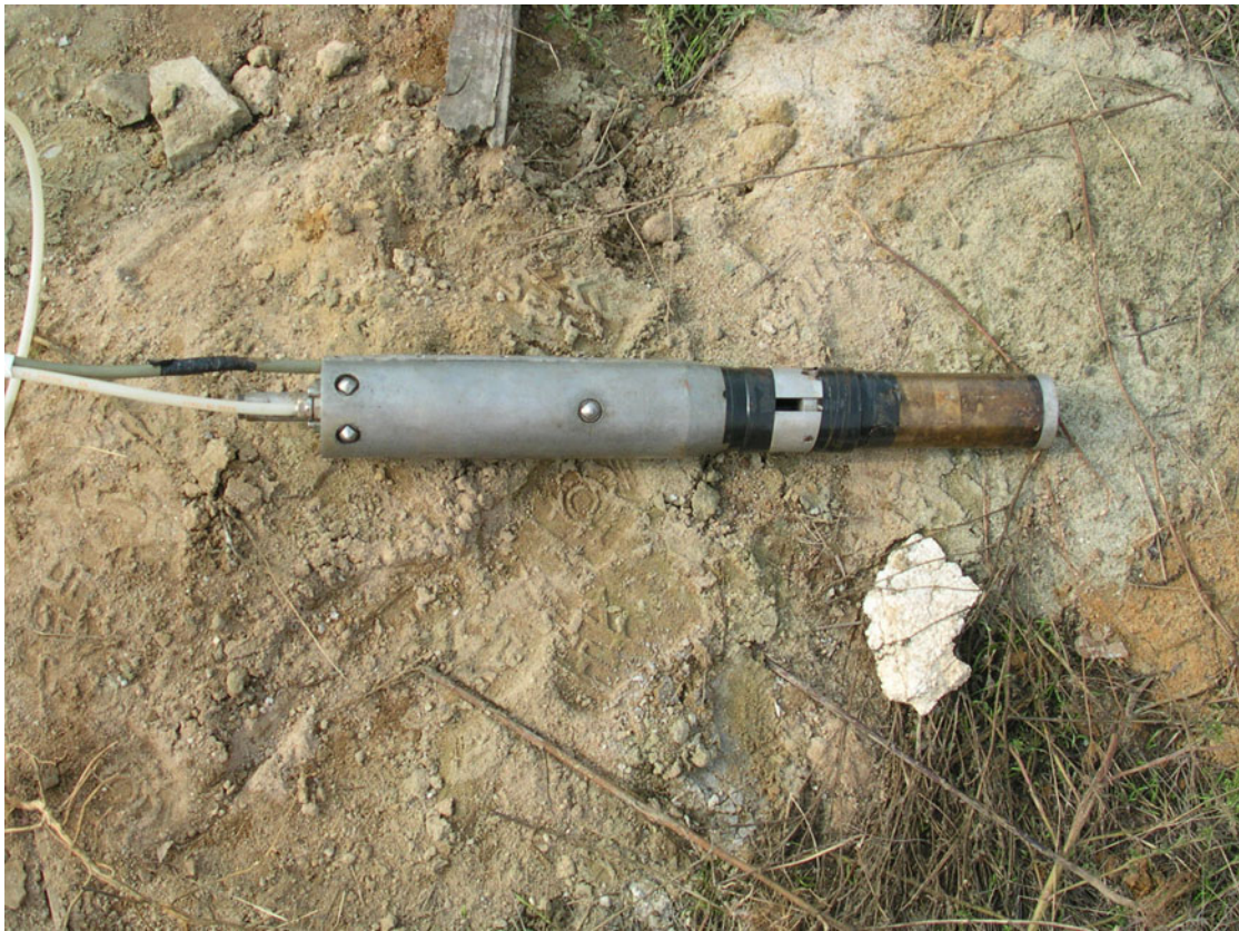
# 2: Ricevitore di onde Sv (Geofono).
